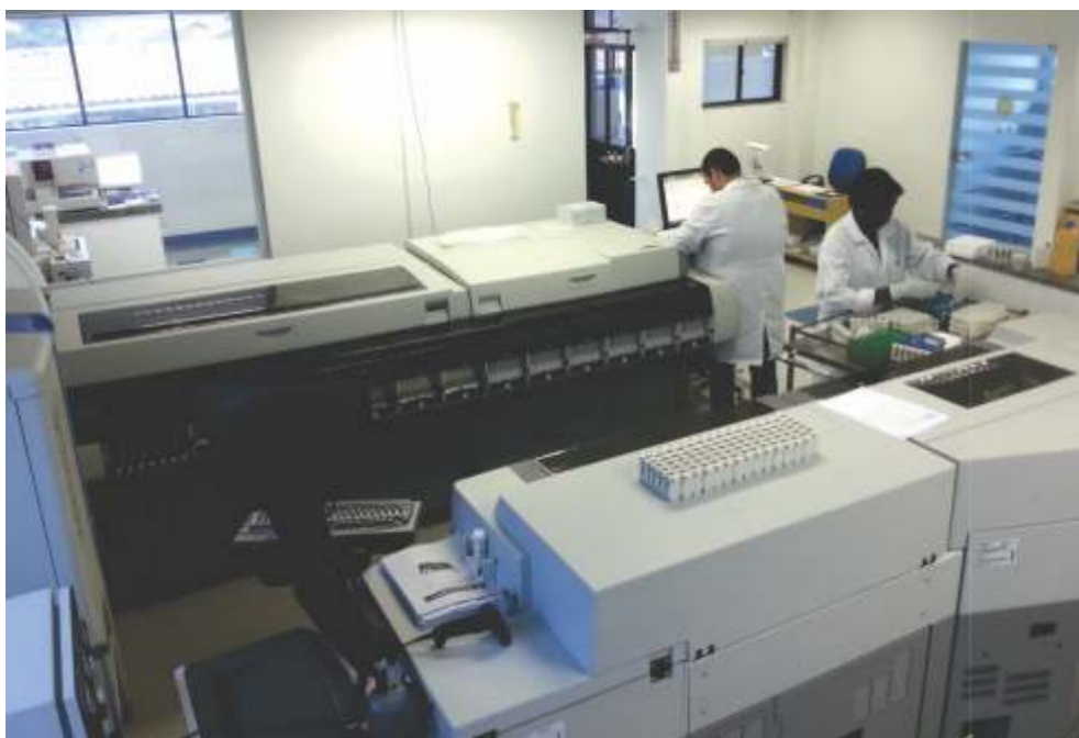
O equipamento realiza 300 análises simultâneas, suprimindo a função de quatro aparelhos diferentes
